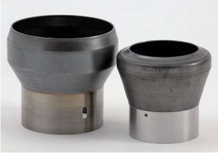
Bild 1: Die Enden der rotationssymmetrischen Hohlkörper werden mittels Beschneiden und Drehen mechanisch bearbeitet und das Flammloch anschließend warm eingezogen.
