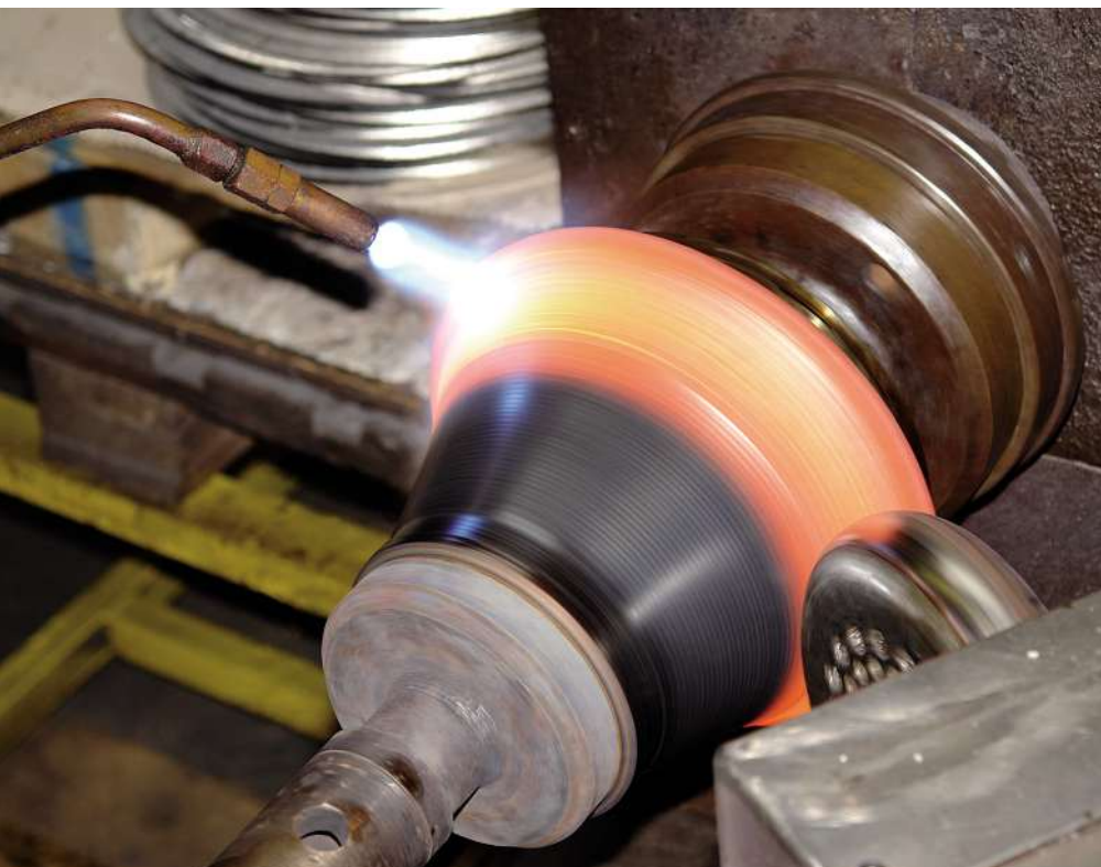
Die Formgebung des Einziehens erfolgt durch entsprechend gesteuerte Drückrollenbewegungen.
